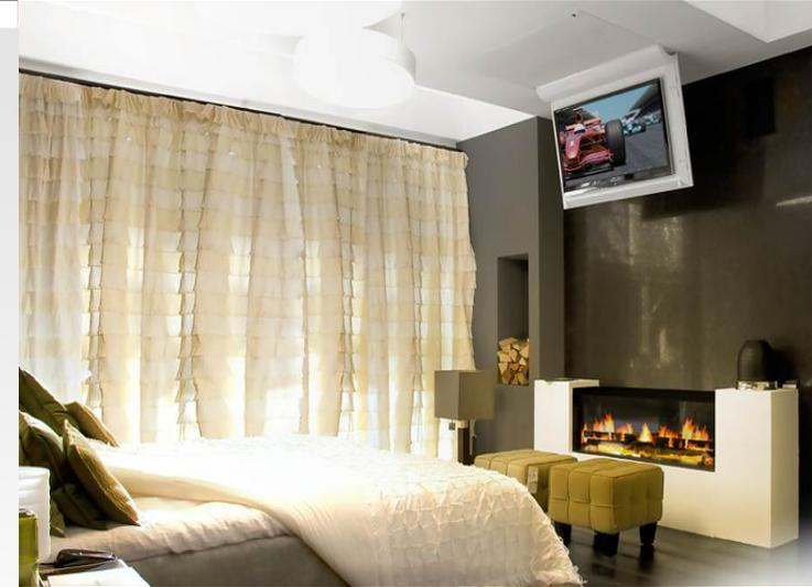
AZIONANDO IL TELECOMANDO, IL MECCANISMO CONSENTE AD UN TELEVISORE INSTALLATO ALL'INTERNO DI UN TELAIO CON CABINET (INCASSATO A SOFFITTO O CONTROSOFFITTO) DI APRIRSI FINO A 100°.
